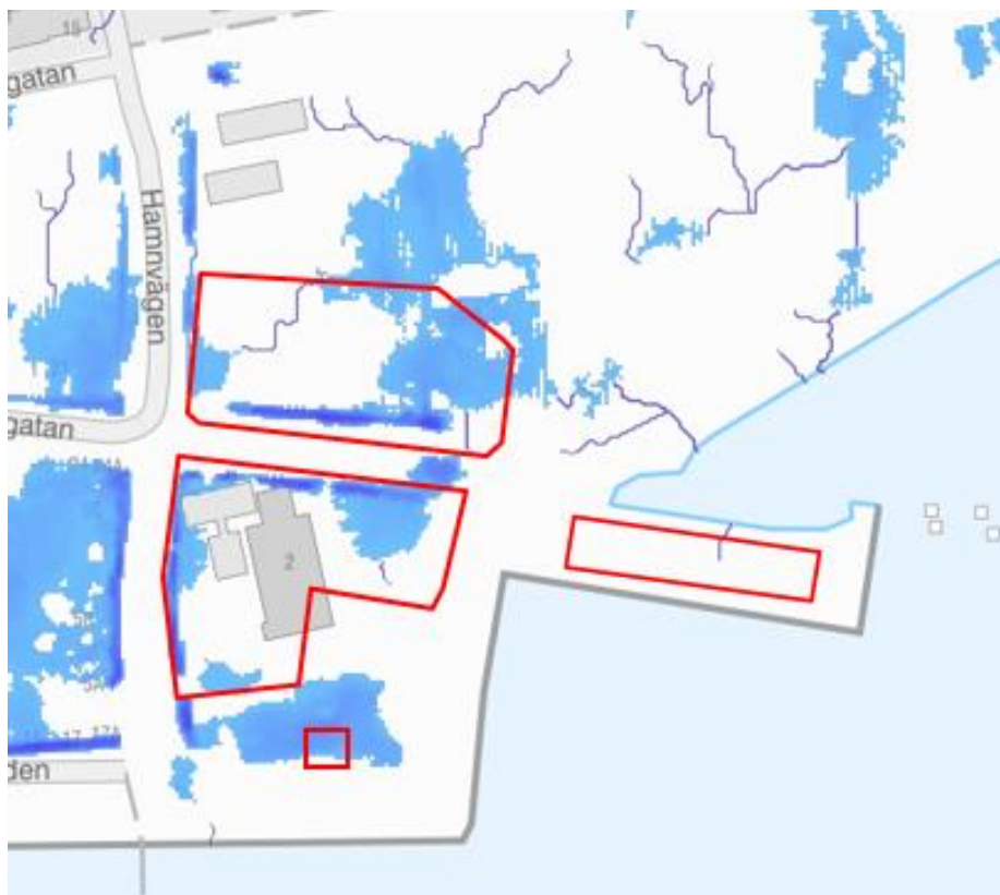
Figur 12. Lågpunkter och avrinningsstråk vid en nederbörd på 68 mm för befintlig situation (mörkblå färg anger maxdjup, SCALGO LIVE).
