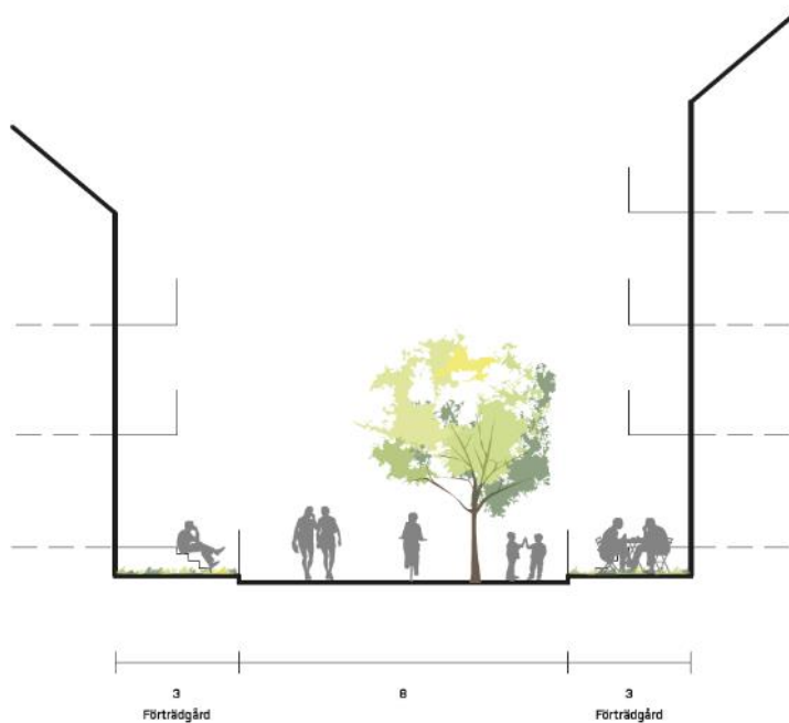
Illustration från kvalitetsprogrammet - Principsektion för gårdsgata - 8 meter bred gatusektion med 3 meter breda trädgårdsvåningar på respektive sida om gatan.
